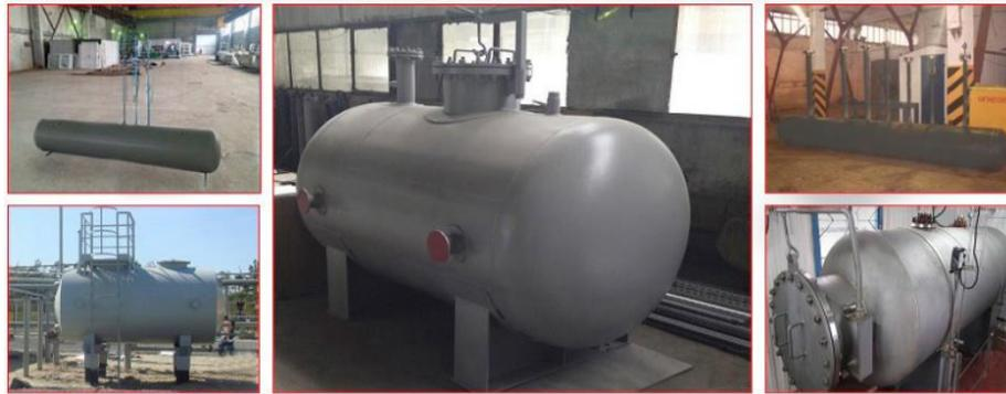
Емкость хранения импульсного газа по конструкторскому исполнению монтажа может быть надземного и подземного исполнения. Конструктивно емкость представляет собой сварной стационарный сосуд цилиндрической формы с эллиптическими днищами, подводящими и отводящими патрубками, запорной и измерительной арматурой, опорами (для надземного исполнения).
